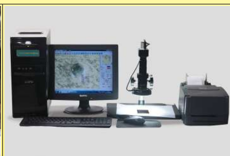
Mesure électronique au microscope du diamètre de l'indentation (Laboratoire Ultimheat)
